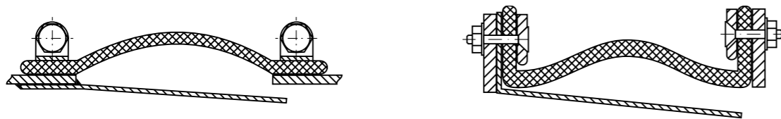
Конструкция с внутренним защитным экраном
